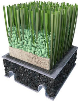
Tout d'abord, des petits trous sont prévus dans le backing du tapis en gazon synthétique, afin de permettre à l'eau de filtrer vers la couche inférieure. Ensuite, la couche inférieure se compose de matériaux extrêmement perméables tels que des gravats, des graviers ou un mélange de substances minérales
